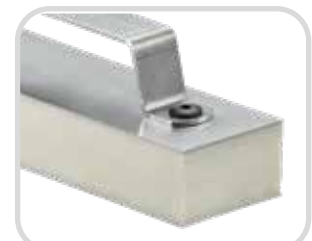
PUR-Schaum + 0,6mm Aluminium AW3003 Auszugskraft 800 N
