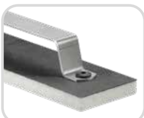
Rohacell-Schaum + CFK-Deckschicht Auszugskraft 1.300-1.700 N
