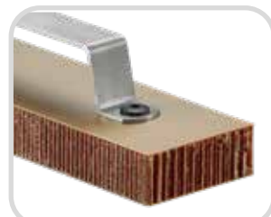
Aramidwabe + Aramidfaser-Deckschicht Auszugskraft 700–1.200 N
