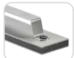
PP-GF-Schaum + PP-GF-Deckschicht Auszugskraft 1.900 N
