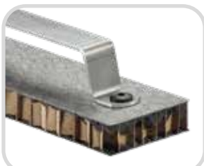
Papierwabe + PUR GF-Deckschicht Auszugskraft 900 N
