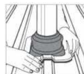
4. A Dektite-t pontosan formálja rá a profilmezére.
