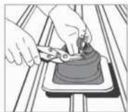
1. Illessze a Dektite-ot a csőhöz.
