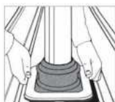
2. Illessze és jelölje a Dektite-t a profilmezén.
