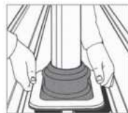
2. Illessze és jelölje a Dektite-ot a profilmezemen.
