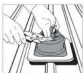
1. Illessze a Dektite-t a csőhöz.
