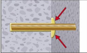
10. Ringspalt zwischen Ankerstange und Verankerungsgrund muss vollständig mit Mörtel gefüllt sein. Bei Durchsteckmontage muss auch der Ringspalt im Anbauteil mit Mörtel verfüllt sein. Andernfalls Anwendung vor Erreichen der maximalen Verarbeitungszeit  $t_{work}$  ab Schritt 8 wiederholen.
