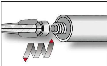
3. Statkmischer SM-14W/PM-19E aufschrauben und Kartusche in geeignetes Auspressgerät einlegen. Bei Schlauchfolienkartuschen den Schlauchfolienclip vor der Verwendung abschneiden. Bei Arbeitsunterbrechungen, länger als die maximale Verarbeitungszeit  $t_{work}$  (Anhang B 5) und bei neuen Kartuschen, neuen Statkmischer verwenden.
