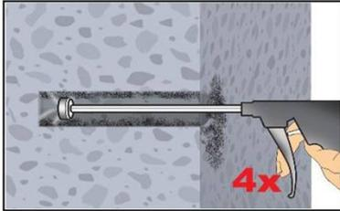
2a. Bohrloch mindestens 4x mit Druckluft (min. 6 bar) (Anhang B 4) über die gesamte Verankerungstiefe (ggf. Verlängerung verwenden) ausblasen, bis die ausströmende Luft staubfrei ist.
