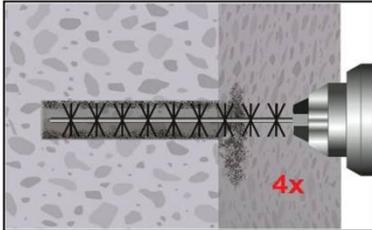
2b. Bohrloch mindestens 4x mit Bürste RBT gemäß Tabelle B4 drehend über die gesamte Verankerungstiefe (ggf. Bürstenverlängerung RBL verwenden) ausbürsten.
